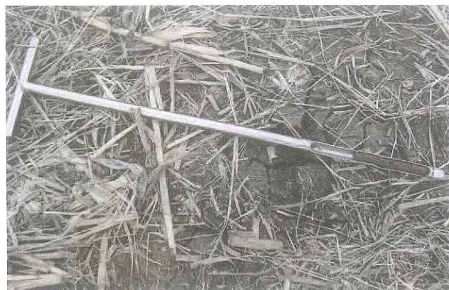
Figura 12. Trado tipo meia-cana para a amostragem e avaliação da disponibilidade de água no solo pelo método do tato-aparência.
