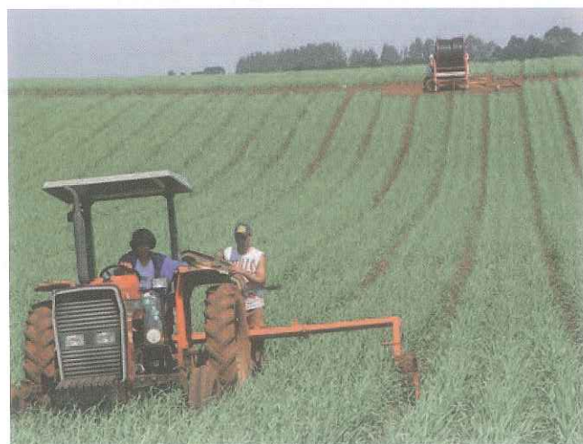
Figura 8. Carretel enrolador (ao fundo) de sistema de irrigação por aspersão tipo autopropelido.
