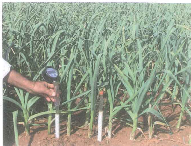
Figura 14. Tensiômetros instalados em duas profundidades para medição da tensão de água no solo com o uso de tensímetro digital.
