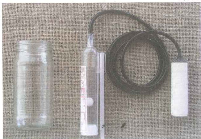
Figura 15. Sensor tipo Irrigas® para avaliação da tensão de água no solo.
