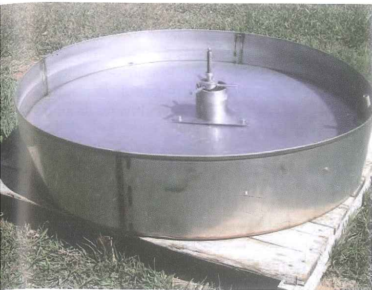
Figura 17. Tanque USWB classe A, com poço tranquilizador e micrometro de gancho, para medição da evaporação de água.
