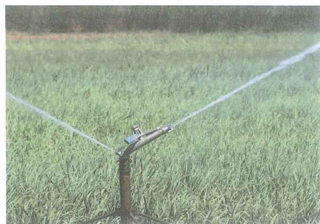
Figura 3. Detalhe de aspersor de impacto tipo canhão hidráulico instalado em sistema de irrigação por aspersão convencional.
