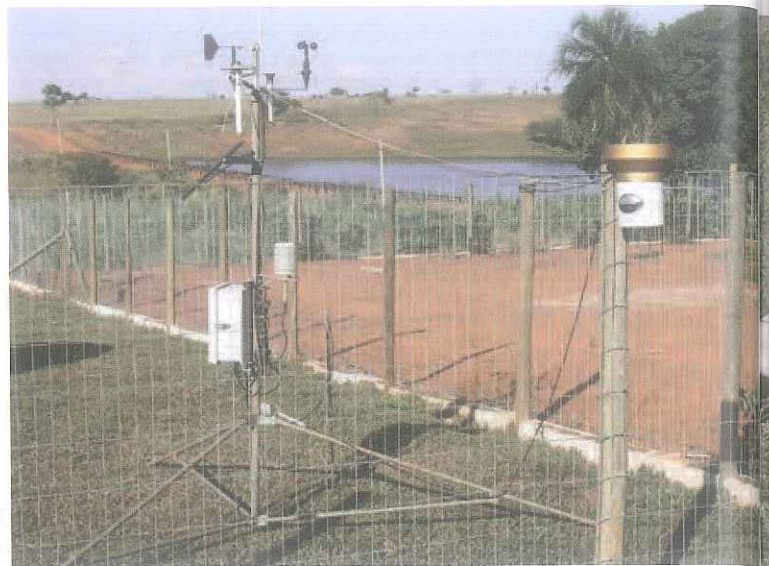
Figura 16. Estação agrometeorológica para medição das variáveis climáticas necessárias para a determinação da evapotranspiração de referência (ETo) pelo método de Penman-Monteith-FAO.
