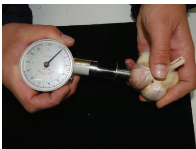
Figura 13 – Medición de la resistencia a la presión
