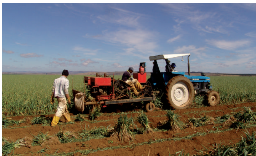
Colheita mecânica – arranca e amarra os molhos
