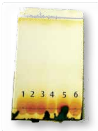
FIGURA 4A | Placa cromatográfica revelada com iodo no eluente AAAA
